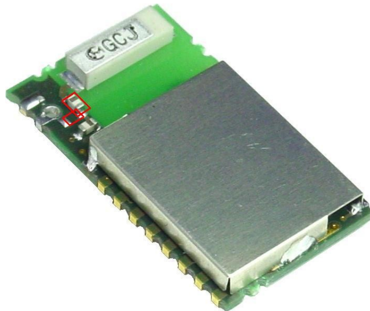
Abbildung 8 Platzierung des Koppelkondensators
